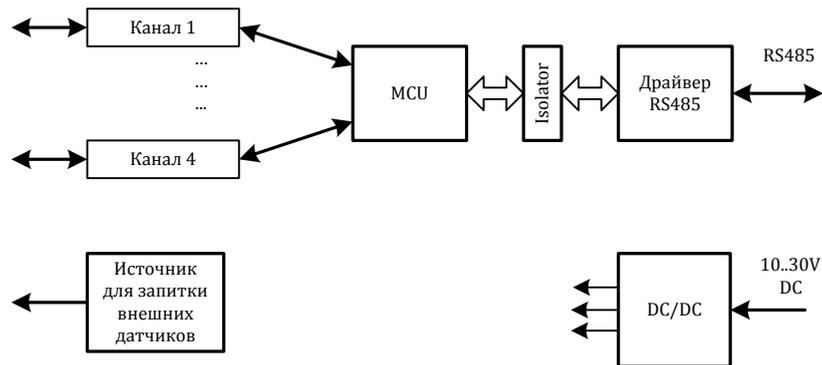
Питание устройства осуществляется от источника, выдающего постоянное напряжение в диапазоне от 10В до 30В. Потребляемая мощность устройства не более 1,5Вт. Питание подается на разъем X1.
