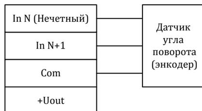
При выборе у одного из каналов модуля режима 5, второй (рядом стоящий) канал автоматически перейдет в этот режим. Четные номера каналов являются основными, нечетные - вспомогательными. При этом основной канал считает всегда на увеличение. Вспомогательный канал считает с учетом направления, а частоту сигнала можно считывать с основного канала.
