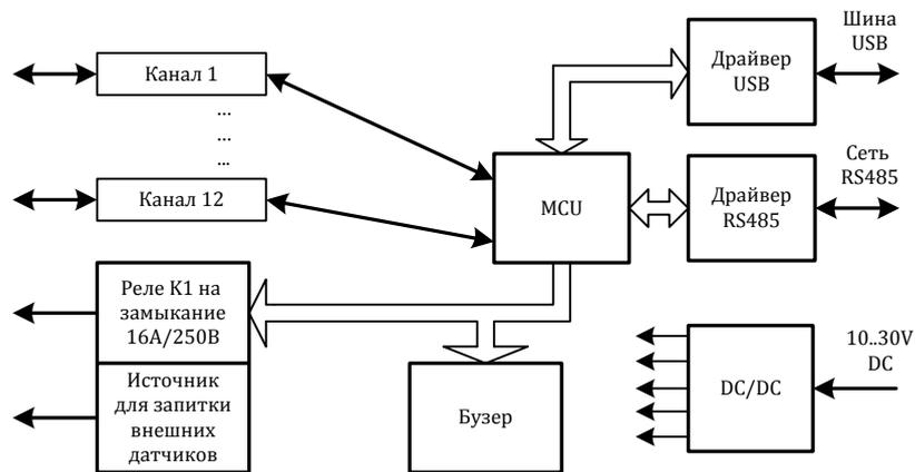
Питание устройства осуществляется от источника, выдающего постоянное напряжение в диапазоне от 10В до 30В. Потребляемая мощность устройства не более 1,5Вт. Питание подается на разъем X5.
