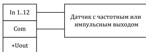
Схема подключения при работе в режиме 5:
