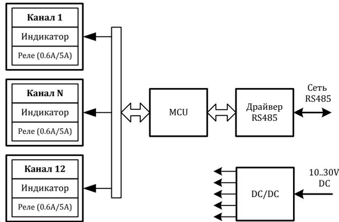
Питание устройства осуществляется от источника, выдающего постоянное напряжение в диапазоне от 10В до 30В. Потребляемая мощность устройства не более 1,5Вт. Питание подается на разъем X5.
