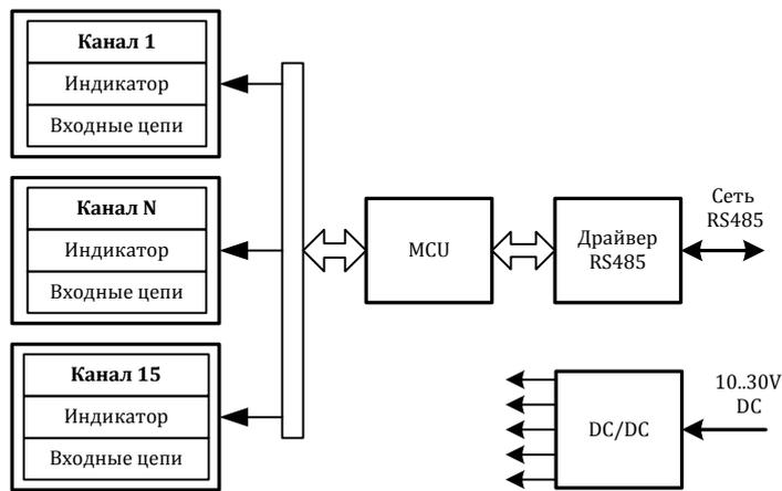
Питание устройства осуществляется от источника, выдающего постоянное напряжение в диапазоне от 10В до 30В. Потребляемая мощность устройства не более 1,5Вт. Питание подается на разъем X5.
