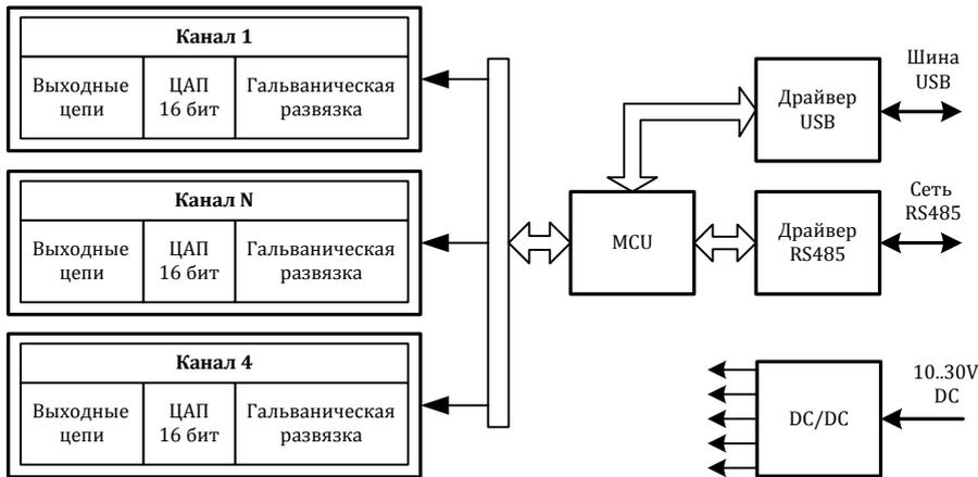
Питание устройства осуществляется от источника, выдающего постоянное напряжение в диапазоне от 10В до 30В. Потребляемая мощность устройства не более 1,5Вт. Питание подается на разъем X5.
