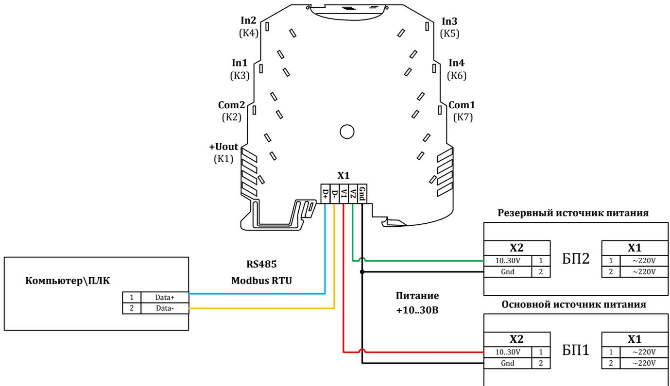
При отсутствии у хоста встроенного интерфейса RS485 нужно применять преобразователь интерфейса, например WAD-RS232/USB/LAN/RS485-BUS.
