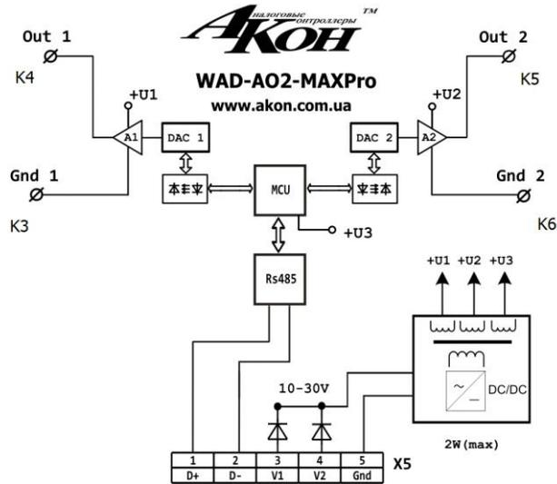
Питание устройства осуществляется от источника, выдающего постоянное напряжение в диапазоне от 10В до 30В. Потребляемая мощность устройства не более 1,5Вт. Питание подается на разъем X5.
