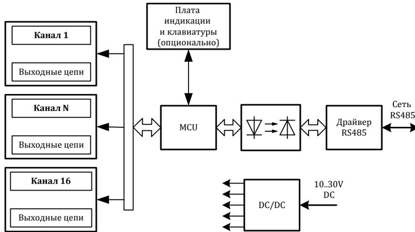
Питание устройства осуществляется от источника постоянного напряжения в диапазоне от 10В до 30В. Потребляемая мощность устройства не более 9,5Вт.
