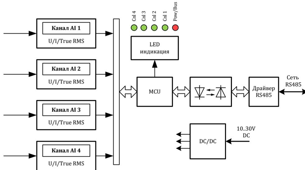
Питание устройства осуществляется от источника постоянного напряжения в диапазоне от 10В до 30В. Потребляемая мощность устройства не более 2,0Вт.
