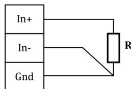
**Измерение сопротивления 3-х проводная схема**
