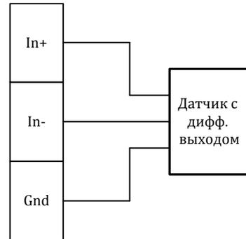
**Измерение напряжения в дифференциальном режиме**
