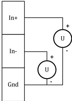
**Измерение напряжения (unipolar)**
