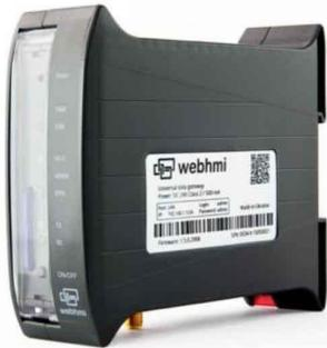
WebHMI позволяет объединить в единую систему набор устройств автоматики и реализовать диспетчерский контроль и управление данной системой, используя обычный веб-браузер, по локальной сети или интернет. Для разработки проекта не требуется высокая квалификация, работа происходит в режиме конфигурирования.
